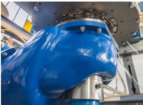
▲ Pumpenmodell einer mehrstufigen Speicherpumpe
